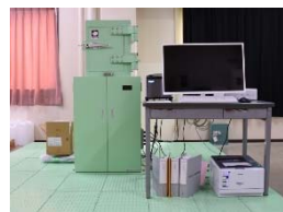
▲ゲルマニウム半導体検出装置
