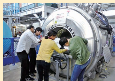
研究室の学生たちがJ-PARC施設内にある実験用MRI超電導磁石装置にて磁場測定作業に取り組む様子。1.7Tの強磁場環境下で実験機材の扱いを慎重に行っています。(飯沼准教授撮影)
